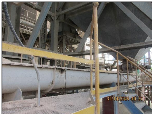
ภาพที่ 2.1 ระบบสายพานแบบปิดสำหรับลำเลียงฝุ่นจาก SP Boiler และ Precipitation Chamber
